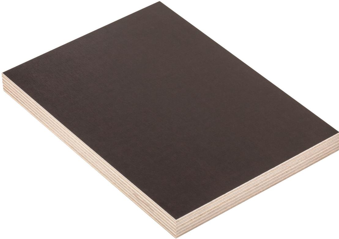
Le Metsä Wood Form est un contreplaqué en bouleau dont les deux faces sont recouvertes d'un film phénolique et dont les chants sont protégés contre l'humidité. Le contreplaqué Form est le matériau de choix pour le coffrage d'éléments en béton à la surface lisse. Il peut également être utilisé comme un matériau de revêtement multifonction et sans entretien dans de nombreuses autres utilisations. Le Metsä Wood Form est disponible dans différentes tailles : standard, L, XL et KingSize.
