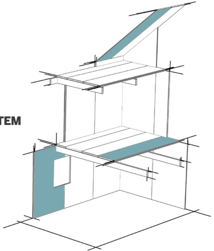
Die Stufenfalzplatte kann wie jedes andere Massivholzbausystem eingesetzt werden, oder in Kombination mit Pfosten und Rahmen.
